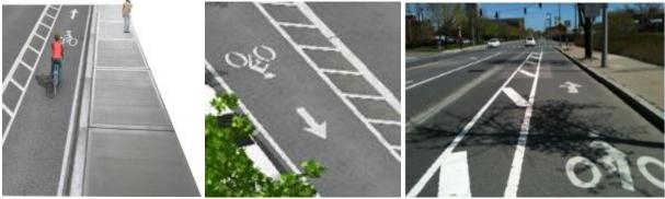
FIGURE 5-2: EXAMPLE BUFFERED BIKE LANES
